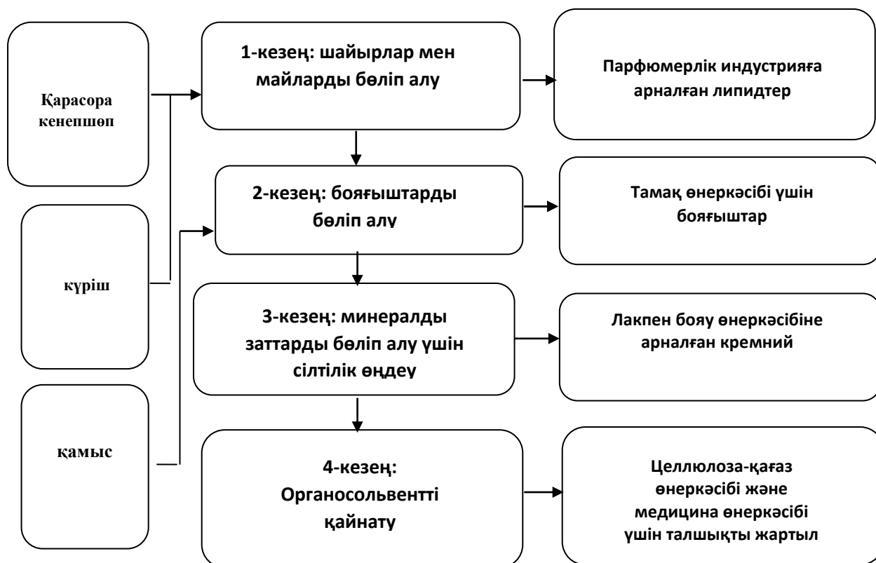
9 Сурет – Ағаш емес өсімдік шикізатынан компоненттерді біртіндеп бөліп алу сызбасы
